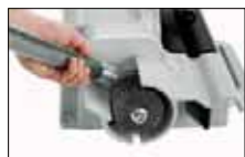
El disco de desbarbado opcional se usa para lijar el diámetro exterior con el fin de contribuir a que la conexión esté más apretada
