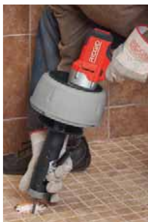
El cable de 3/8" (10 mm) del modelo K-45AF-5 amplía la capacidad de la máquina hasta acometidas de desagües de 2 1/2" (75 mm).
