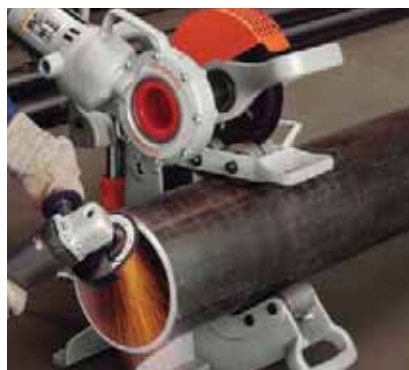
Modelo 258 con cortatubos en uso para biselar. Se recomiendan dos operadores para esta operación
