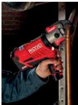
Mordazas de la serie compacta para cobre, acero, acero inoxidable, PEX y multicapa. Consulte la página 10.6
