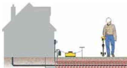
Conecte directamente a acometidas de servicios públicos.
