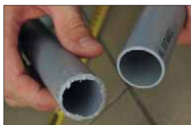
Corte con una sierra para metales (izquierda) frente a la P-TEC 3240 (derecha).
