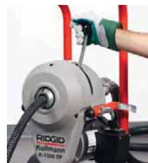
Suelte la empuñadura, el cable se detiene al instante
