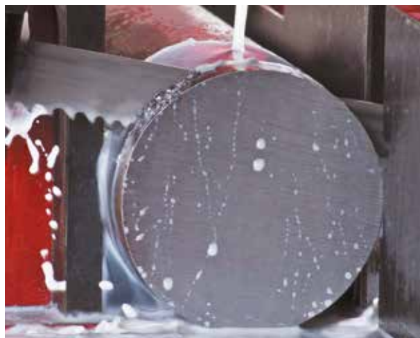
Después del ablandamiento (20 a 30 minutos), aumente el avance gradualmente hasta alcanzar el avance de corte recomendado.
