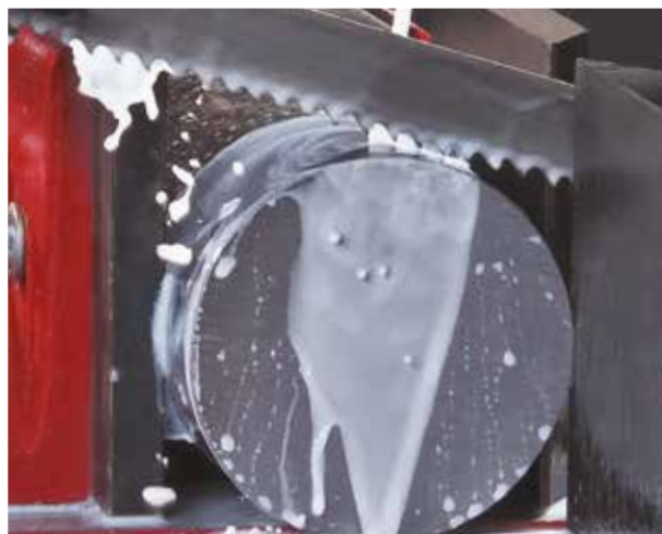
Comience a cortar el material con un avance de corte reducido.
